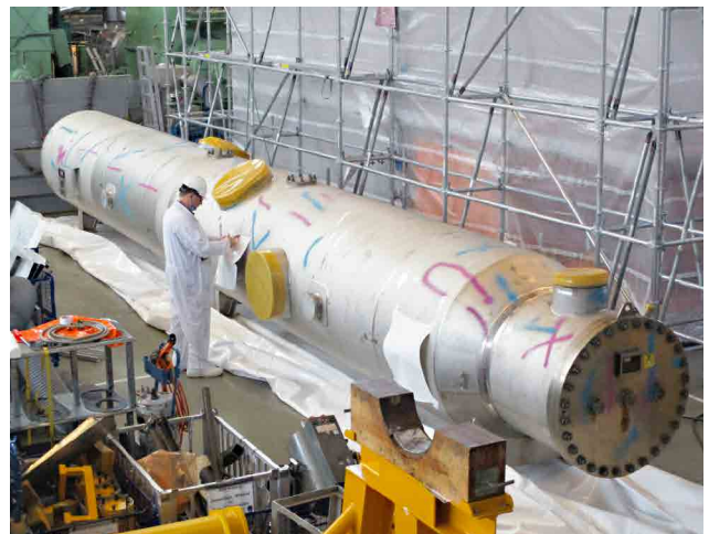
Pendant les premiers mois suivant l'arrêt, des turbines, des générateurs et de gros composants individuels ont été mis hors service et démontés dans la salle des machines.
