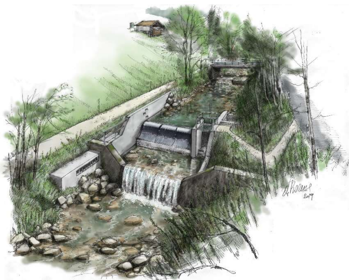
Visualisierung der Wasserfassung des Kraftwerks Turbach.
