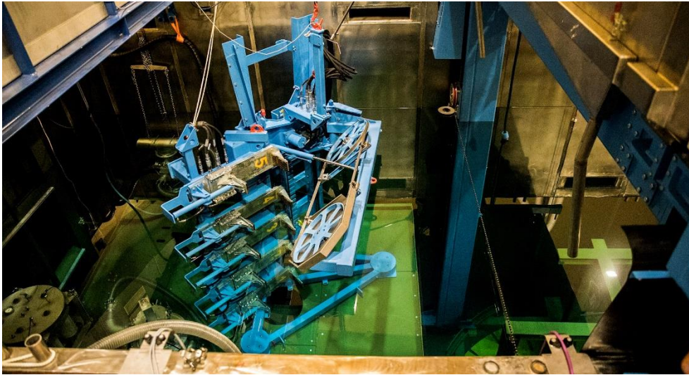
Die Werkzeuge für das Zerschneiden der Kerneinbauten unter Wasser.
